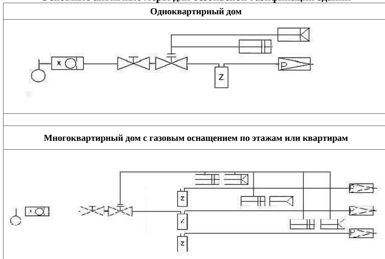
Рисунок Д.1 – Активные меры безопасности при давлении в наружном газопроводе свыше 0,0025 МПа до 0,005 МПа включительно и приборы, регулирующие давление газа
